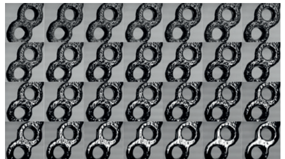
Makrosequenz eines Polierverfahrens mit DryLyte Technology.
